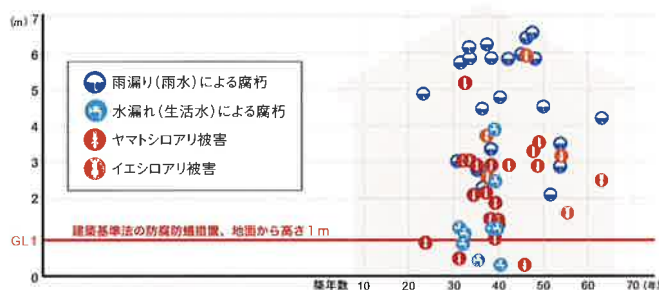
築年数による腐れ被害とシロアリ被害の状況
